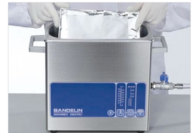
Auf einem Folienteststrahlen aufgespannte Folie
