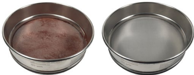
Analysensieb vor und nach der Reinigung
