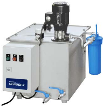
Ölabscheider OX 75 bestehend aus: Ölabscheider OX 500, Anschlusssatz AOX 40/75 Best.-Nr. 8602A
